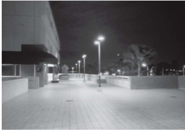
Scène similaire à la précédente avec des luminaires équipés de dispositifs orientant la lumière vers le bas pour empêcher la déperdition.
